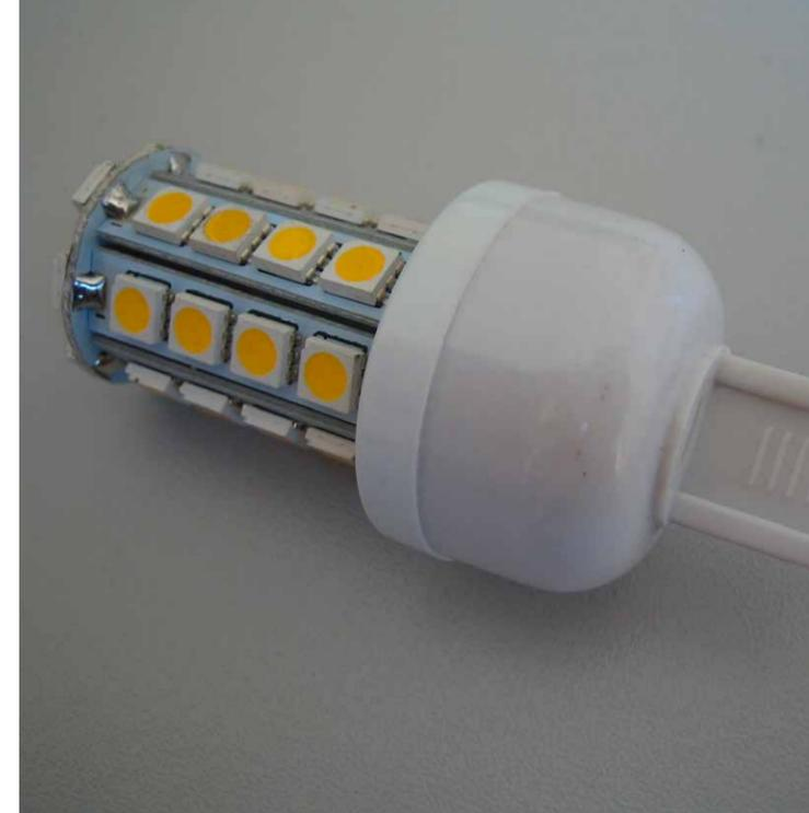
Abbildung 2: Zusammengeschaltete Einzel-LEDs mit G9-Sockel
