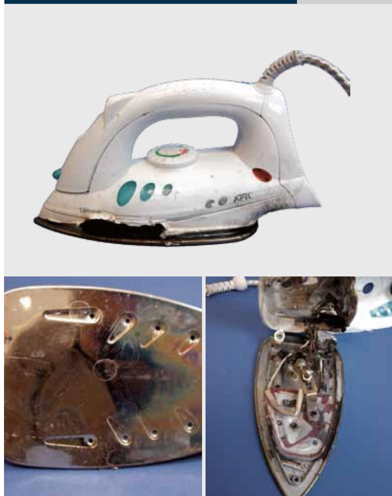
Bild 2: Brandschaden an einem Bügeleisen nach Ausfall des Sicherheitstemperaturbegrenzers
