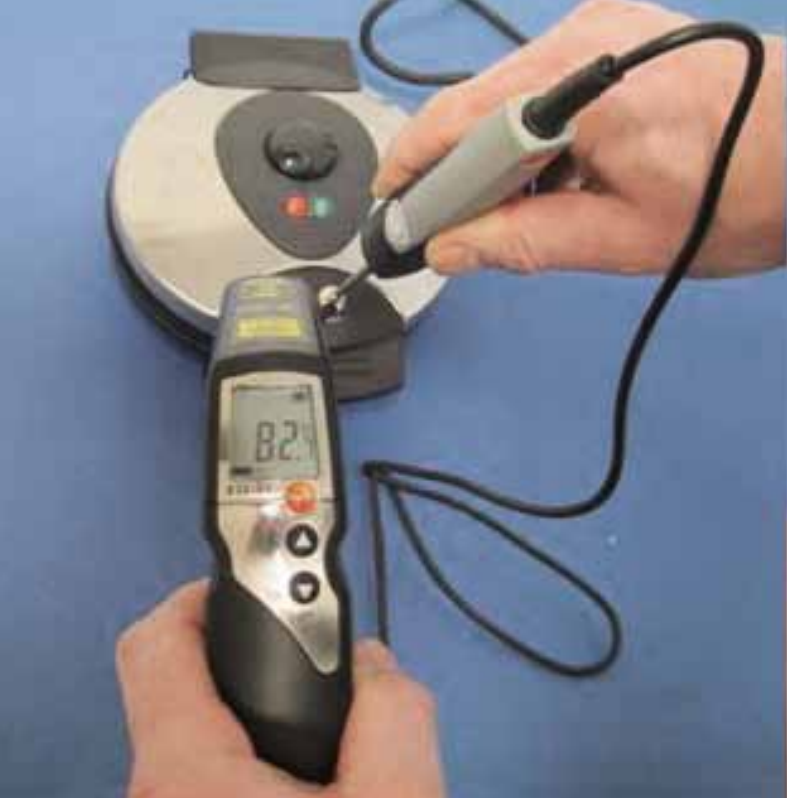
Bild 1: Messung der Oberflächentemperatur am Kunststoffgriff und auf dem Metallgehäuse eines Waffeleisens
