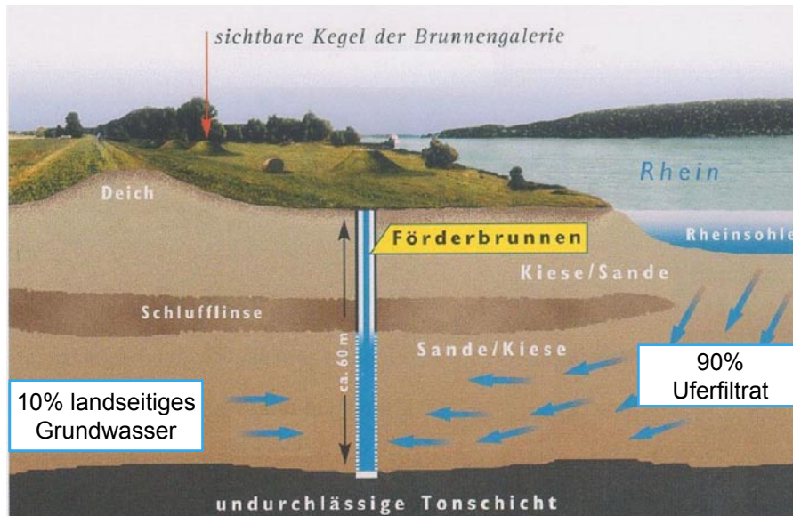
Beispiel einer Uferfiltratgewinnungsanlage am Rhein (Quelle: Mit freundlicher Genehmigung durch die Wasserversorgung Rheinhessen GmbH, Bodenheim)
