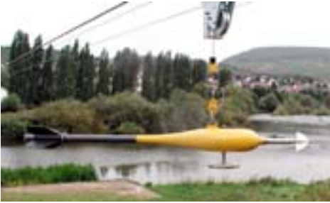
Hydrometrischer Schwimmflügel, bestehend aus Schwimmsteuer, Mittelstück (100 kg) und Schaufel
