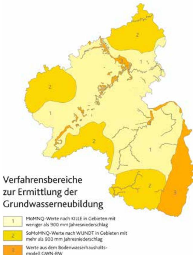
Abb. 16: Verfahrensbereiche zur Ermittlung der Grundwasserneubildung
