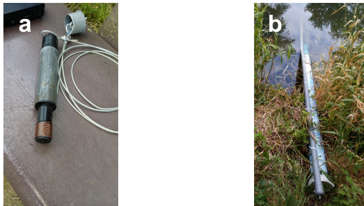
Abb. 7: a: HOBO®-Logger mit Sicherungsdrahtseil und PVC Verschlusskappe; b: Installation der Sonde im Gewässer in Führungsrohr aus PVC.
