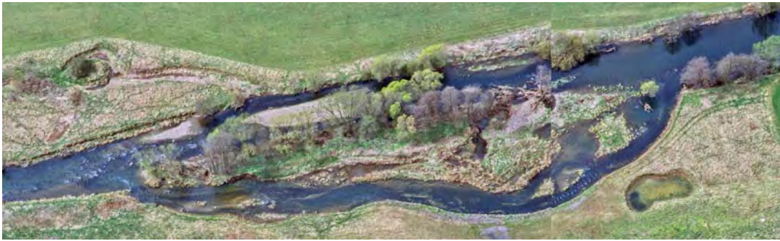
Abb. A.2: Gewässertypgerechte Entwicklung eines Standortes an der oberen Lahn: die ursprünglich vorhandenen Furkationen stellen sich wieder ein und bilden durchwanderbare Gewässerarme mit natürlichem Sohlengefälle. Die Gewässerarme sind gegenüber Fischaufstiegsanlagen, die das Gefälle lokal konzentrieren, weniger wartungsintensiv und ökologisch hochwertiger.
