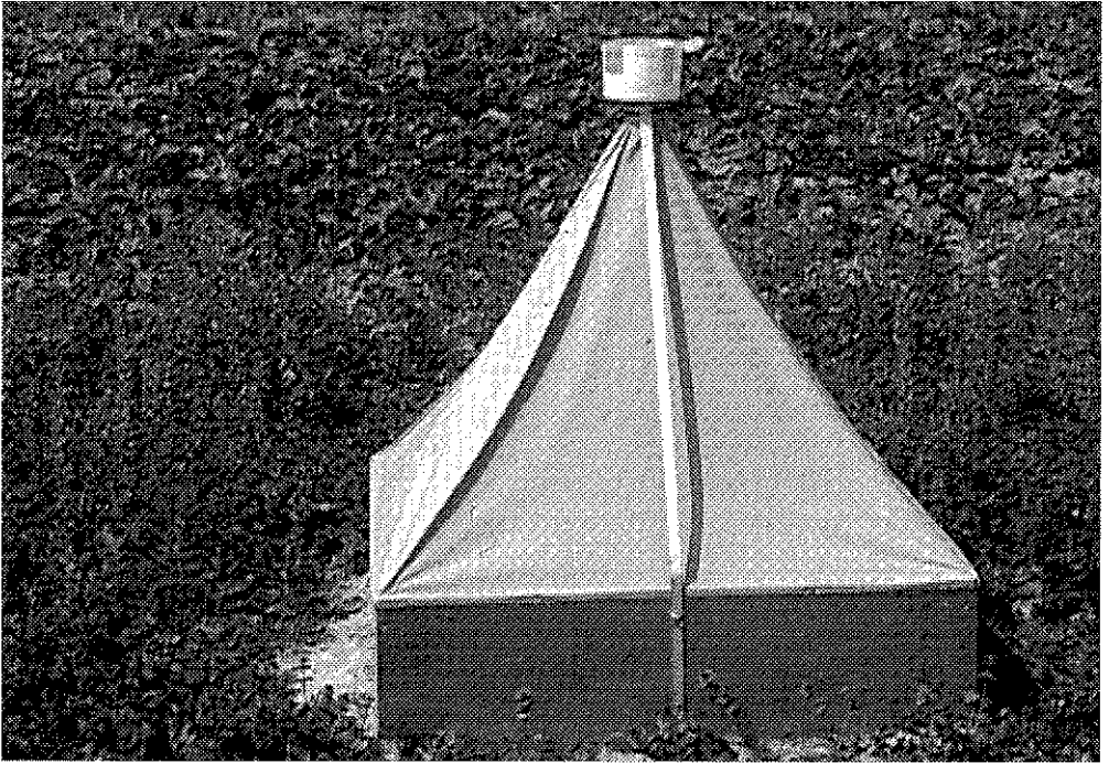
Abb. 1.1/18: Bodenphotoelektor, verändert nach FUNKE (1971).
