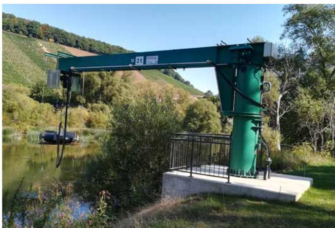
**Kran mit Messwasserpumpe für die Wasserentnahme**
