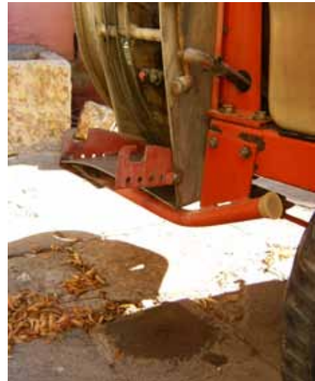
Abb. 64: Tropfverlust auf Hoffläche
