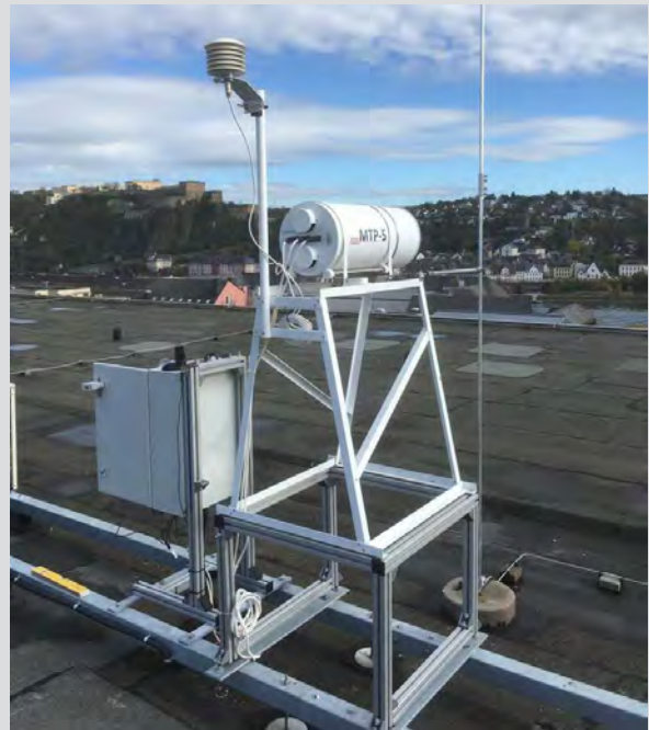
Das neue Mikrowellenradiometer steht auf dem Dach des Hauptjustizgebäudes in Koblenz. Es misst die von den Sauerstoffmolekülen der Atmosphäre emittierte Mikrowellenstrahlung.
