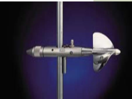
Der hydrometrische Flügel misst die Fließgeschwindigkeit in Meter pro Sekunde.
