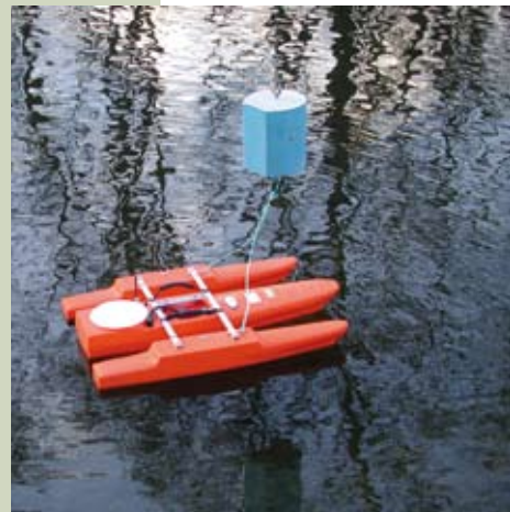
Die ADCP-Technik ermöglicht die Abflussmessung mit Hilfe von Ultraschall.
