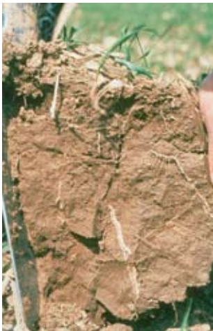
Foto 14: Grobprismatisches Gefüge mit fast geschlossener Lagerungsart eines stark verdichteten Horizontes mit hoher Packungsdichte; die Wurzeln sind durch hohen Quellungsdruck platt gepresst [Foto: T. Harrach]
