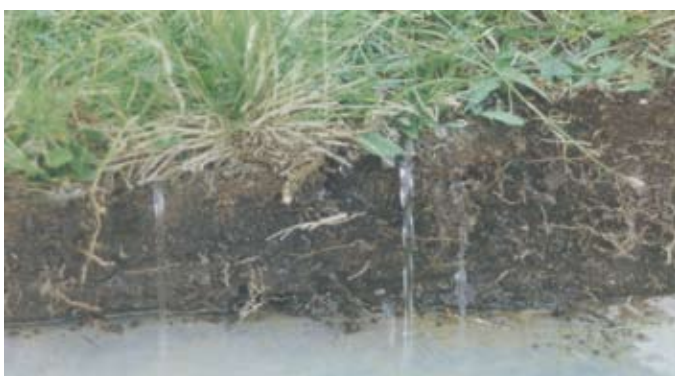
Foto 20: Hydrophobe Verhältnisse zu Beginn eines Beregnungsversuchs. Das Wasser benetzt den Boden nicht und fließt konzentriert über die Kante aufs Auffangblech. [Foto: S. Scherrer]
