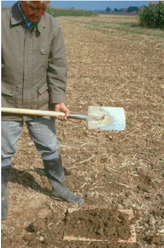
Abb. 4: Abwurfprobe zur Bestimmung des Zusammenhaltes bzw. des Verfestigungsgrades, hier „loser Zusammenhalt“ und geringe Packungsdichte (Diez & Weigelt 1997)
