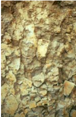
Foto 16: Polyedergefüge mit halboffener bis fast geschlossener Lagerungsart in einem Pelosol-Pseudogley mit mittlerer bis hoher Packungsdichte [Foto: Vorderbrügge]
