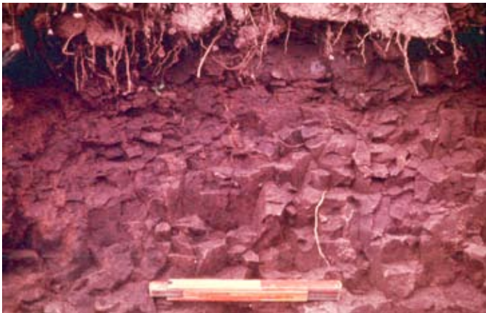
Foto 13: Polyedergefüge mit geschlossener Lagerungsart in einem tonreichen Boden mit sehr hoher Packungsdichte [Foto: Schulte-Karring]
