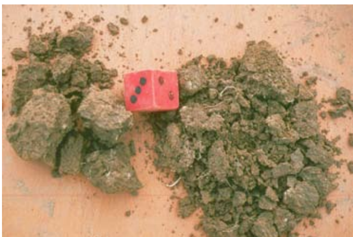
Foto 12: Ergebnis der Abwurfprobe: Links mittlerer Zusammenhalt, rechts sehr loser bis loser Zusammenhalt [Foto: Diez & Weigelt, 1997]
