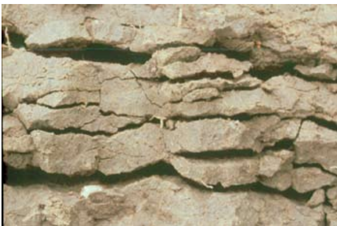
Foto 9: Plattengefüge aus der nicht bearbeiteten Unterkrume einer Parabraunerde aus Löss mit geschlossener Lagerungsart und hoher Packungsdichte [Foto: Diez & Weigelt, 1997]
