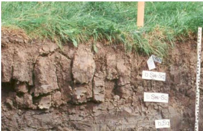
Foto 11: Säulengefüge im Knickhorizont einer Knickmarsch mit fast geschlossener Lagerungsart und hoher Packungsdichte [Foto: S. Sauer]
