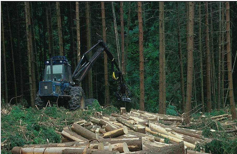
Harvester-Einsatz auf Landesfläche beim Fich- teneinschlag.
