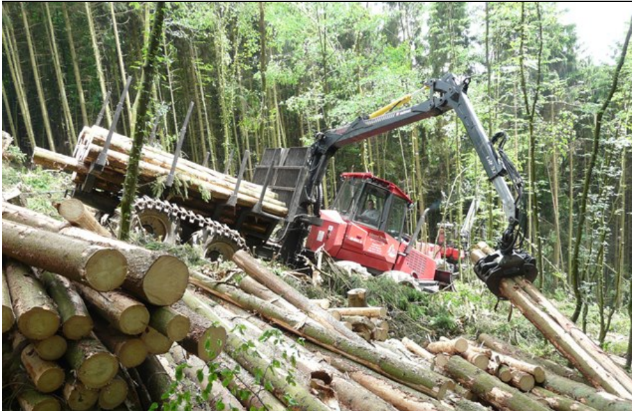
Holzernte im NABU-Wald mit kettenbetriebenen Vollernter im Steilhang.
