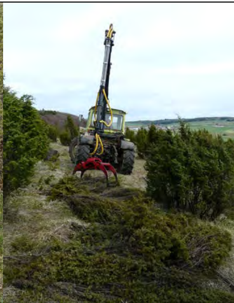
Links: Selbst gebautes Werkzeug zum Herausziehen abgeschnittener Wacholdergebüsche
