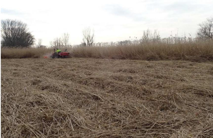
Zum Befahren der Riedflächen ist eine Maschine mit einem geringen Bodendruck erforderlich.
