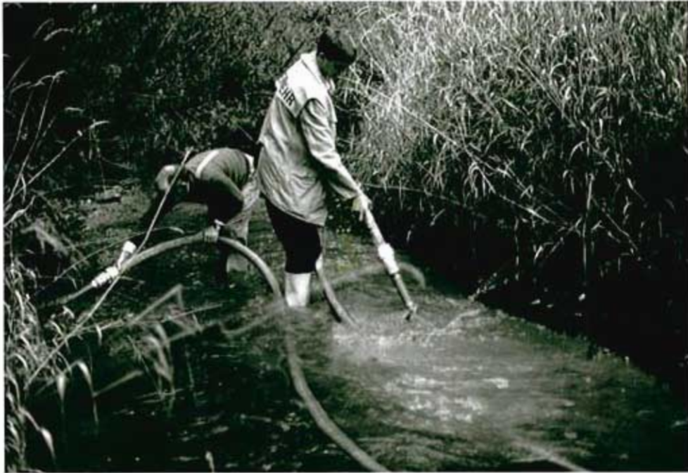
Abbildung 3: Versuch zur Substratreinigung oberhalb der Kuhbrücke mit Tiefenspülung durch die Freiwillige Feuerwehr Pronsfeld am 03. Oktober 1988
